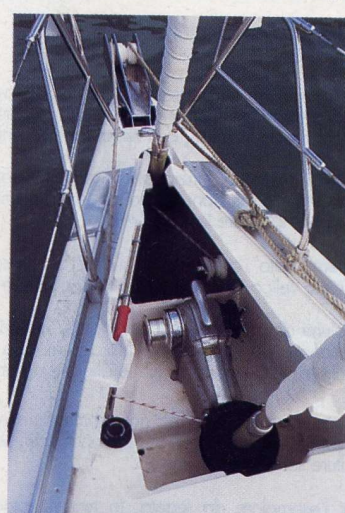
Sul modello crociera, il musone per l'ancora fuoriesce dalla prua. Gli avvolgifiocco sono incassati.
