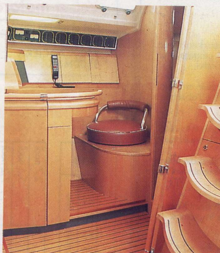
Il piano del carteggio misura cm 75x70 ed è contornato da un'ampia consolle per gli strumenti, la seduta è comoda.
