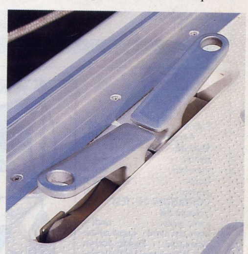
La rivoluzionaria bitta del 52: premendo, scompare a filo del ponte, così da eliminare le "ciabatte" in regata. Efficace l'antisdrucchiolo.
