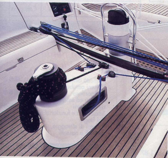
La randa e le ritenute del carrello si manovrano da questa consolle, dotata di winch. Il paranco di scotta a una sola via assicura molta rapidità nella regolazione.
